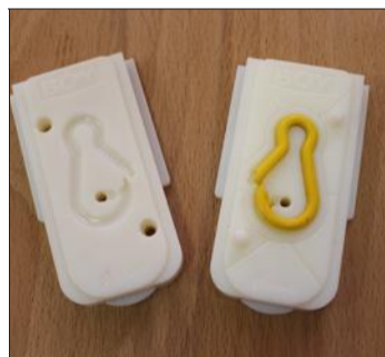
L'empreinte de ce mousqueton et l'objet lui-même sont en thermoplastique. Ils ont été fabriqués sur une presse à injecter, qui sera présentée au salon Decktech.
